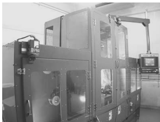
図2 新開発のマルチワイヤ放電スライシング装置
